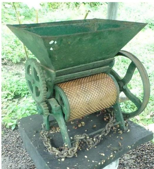
Ilustración 58. Despulpadora (Elise Bouëdron)
