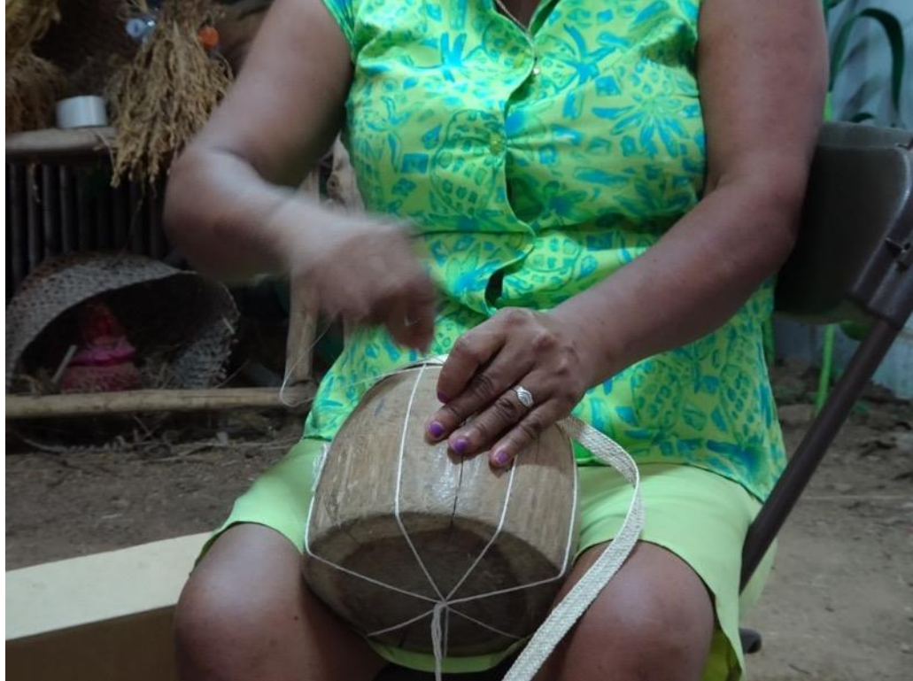
Ilustración 74. Foto de la etapa del armado del sombrero (se cosen las trenzas con un hilo de pita alrededor del molde) (fuente: Elise Bouëdron)
