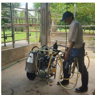
Ilustración 96: Máquina de ordeño móvil con piso de ordeño de concreto (Julie Krémer, 2024)
