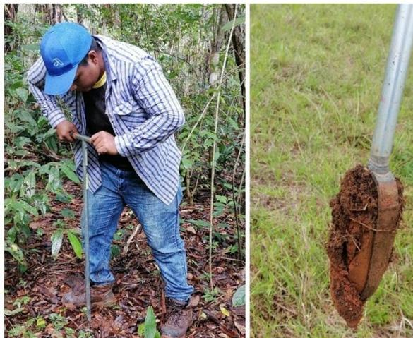
**Figura 4** Muestreo de suelo con Barreno Holandés por el método aleatorio simple, completamente al azar.
