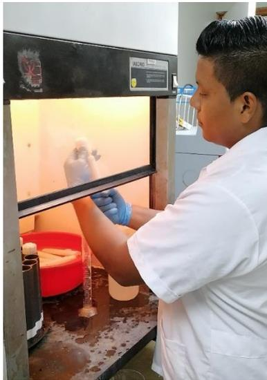
**Figura 9** Preparación de los extractos de las muestras de suelo.
