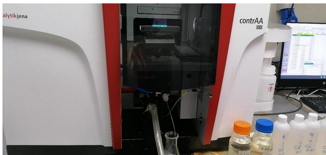
**Figura 11** Calibración del Espectrofotómetro de absorción atómica, para lecturas de los extractos de suelo.
